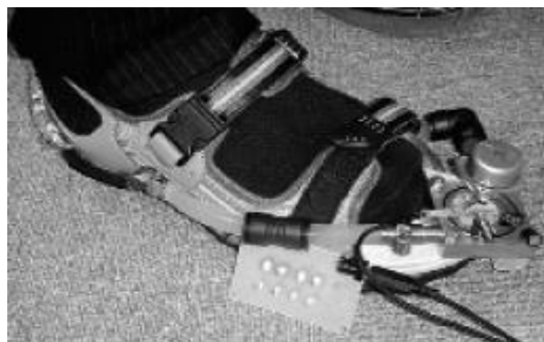
Рис.4. Конструкция установки гидротурбины в обувь
