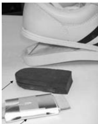
Рис. 5. Установка пьезогенератора в обувь
